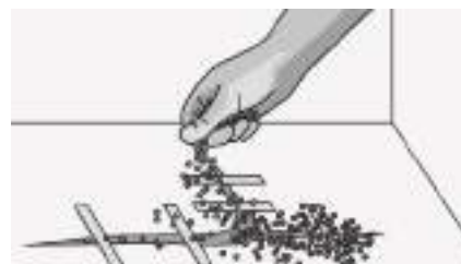
Рис. 7. Дополнительно засыпать трещину или стык большим количеством песка
