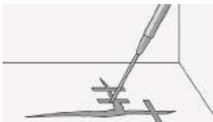
Рис. 4. Перед заливкой ремонтной смолы необходимо удалить грязь и пыль из трещины при помощи пылесоса
