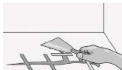
Рис. 6. Убрать выступающую на поверхность смолу
